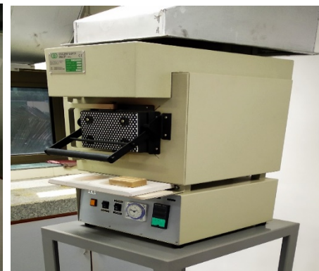
Cupellation Furnace FCOPP/F - Italmimpianti
